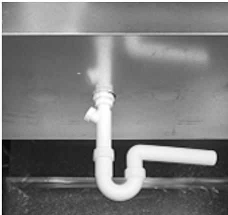
Der Ablauf der Umluft-Kühlwanne Multifunktion führt unten aus der Umluft-Kühlwanne heraus und sollte durch autorisiertes Fachpersonal an eine bauseitige Abwasserleitung angeschlossen werden. Es muss ein Siphon unterhalb der Umluft-Kühlwanne Multifunktion installiert werden, um eine Benachteiligung durch Gerüche nach HACCP zu vermeiden.
