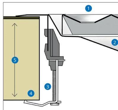
**Querschnitt** Trägerplatte und Einlass-Schänken
