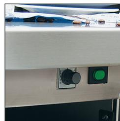
beleuchteter Hauptschalter, stufenlos regulierbar von 30 – 80 °C
