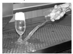
Getränkereste können über die Prismenlochplatte ausgegossen werden (kein Trichter im Standrohr nötig!). Nach dem Ausgießen von Getränkeresten Prismenlochplatte mit klarem Wasser nachspülen.
