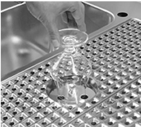
Der Gläserdruckspüler hat die Funktion, ein sauberes Glas von innen zu befeuchten und zu kühlen, um ein besseres Schankergebnis zu erzielen. **Er dient nicht der herkömmlichen Reinigung von verschmutzten Gläsern.** Der Teller wird mit dem aufgesetzten Glas herunter gedrückt. Dadurch wird das Glas von innen mit kaltem, klarem Wasser gespült.
