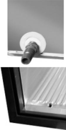
Der Bodenablauf ist mit einem **integrierten, eingeschäumten Geruchsverschluss** (Siphon) versehen und an der bauseitigen Abwasserleitung durch autorisiertes Fachpersonal anzuschließen. Es sollte kein zusätzlicher Siphon außerhalb des Kühlmöbels installiert werden, da dies zu einem schlechteren Abfließen führen könnte.
