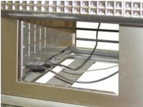
Das im Zubehör enthaltene Netzkabel ist an dem Steckeingang der Anschlussplatte (**siehe Foto**) anzuschließen und zur Stromquelle zu verlegen.
