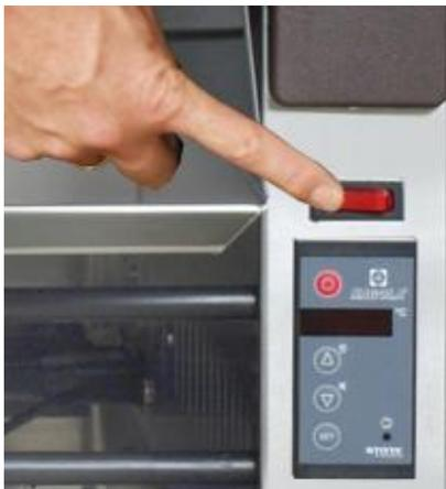
Die Kühlung wird mit dem Stand-By-Schalter ausgeschaltet. Hierzu muss der Schalter (Taste) für mindestens 5 Sekunden gedrückt werden (**siehe Foto**).
