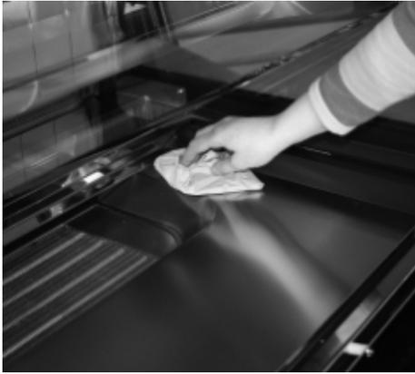
Die Reinigung der Bodenwanne erfolgt mit einem feuchten Tuch und einem synthetischen Reinigungsmittel. Festhaftende, schwere und zähe Fette müssen mit geeigneten Reinigungsmitteln (z. B. Alkohol) entfernt werden. Das anschließende Trocknen der gereinigten Teile ist notwendig **(siehe Foto)**.
