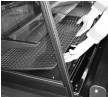
Prismenplatten aus dem Boden des Kühlkorpus heben (**siehe Foto**).
