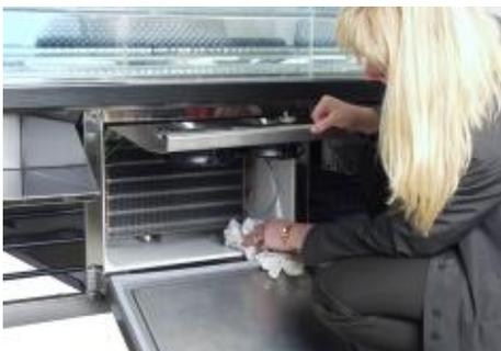
Nach der Reinigung die Lüfterklappe nach oben aufschwenken und mit einer Hand geöffnet halten.
