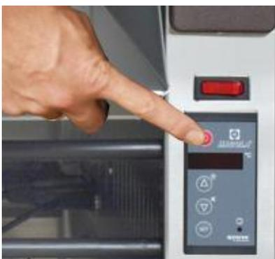
Nach Anschluss der Stromversorgung zur Inbetriebnahme der Frischwaren-Theke den Stand-by-Schalter für 5 Sekunden betätigen (siehe Foto).
