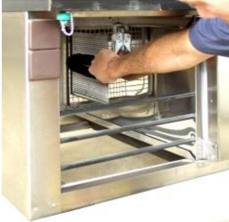
Nach Bedarf den Wärmetauscher mit einem Handfeger und einem Staubsauger reinigen (**siehe Foto**).
