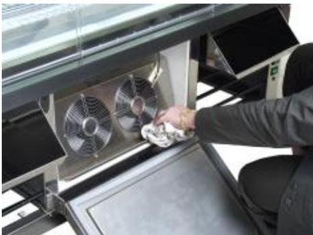
Nach dem Öffnen der Frontklappe ist die Rinne der Lüfterklappe mit einem feuchten Tuch auszuwischen **(siehe Foto)**.
