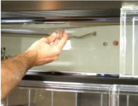
Die Beleuchtungsschalen der Auslagenbeleuchtungen sind aus ihren Halterungen zu entnehmen. Hierzu mit einem Finger in die Aushalsung der Beleuchtungsschalen greifen. Mit der zweiten Hand die Beleuchtungsschalen durch leichtes Ziehen herausnehmen **(siehe Foto)**.
