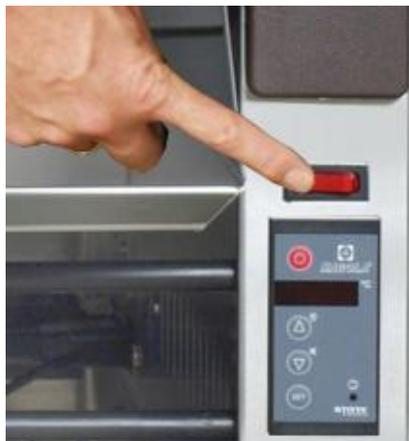
Mit dem Beleuchtungsschalter kann unabhängig von der Kühlfunktion die Beleuchtung an- und ausgeschaltet werden (**siehe Foto**).
