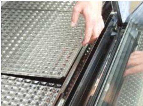
Nach dem Reinigen sind die Prismenplatten in ihre Halterungen einzusetzen.
