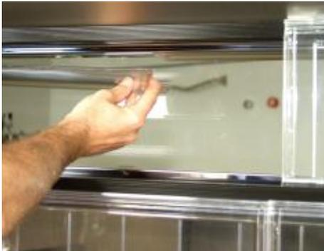
Die **Beleuchtungsschalen** der Auslagenbeleuchtungen sind zur Reinigung aus ihren Halterungen zu entnehmen. Hierzu mit einem Finger in die Aushalsung der Beleuchtungsschale greifen . Mit der zweiten Hand die Beleuchtungsschale durch leichtes Ziehen herausnehmen (**siehe Foto**).
