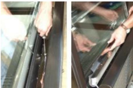
Die drei Befestigungsschrauben der Beleuchtungseinheit lösen und die Beleuchtungseinheit durch gleichzeitiges Kippen nach oben herausheben **(siehe Foto)**.
