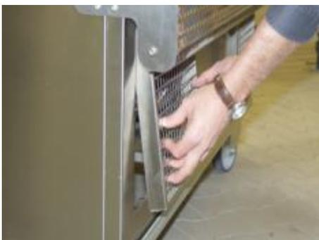
Durch Herausnehmen/Heben des **gastseitigen, linken Lüftungsgitters** ist die an der Anschlussplatte befindliche Steckerbuchse leicht zugänglich. Hierzu wird das Lüftungsgitter gleichzeitig nach oben geschoben und nach vorne gezogen (**siehe Foto**).
