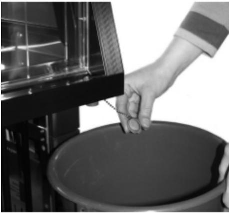
Tauwasser und Reinigungsflüssigkeiten werden über die integrierten Ablaufstutzen entfernt. Hierzu wird der Ablaufstutzen geöffnet und unter Zuhilfenahme eines Behälters die Flüssigkeiten abgelassen (**siehe Foto**).
