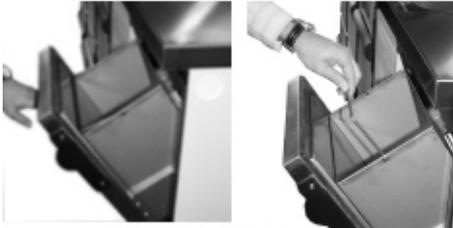
Auf Wunsch kann ein **Abfallkipper** eingebaut werden, der durch Ziehen am Design-Griff bis zum Anschlag aufklappt. Zum Entleeren kann der Edelstahl-Abfalleimer am Bügel nach oben entnommen werden. Nach dem Entleeren wird der Edelstahl-Abfalleimer mit dem Bügel an den Halteblechen an der Innenseite der Abfallkipperfront wieder eingehängt.
