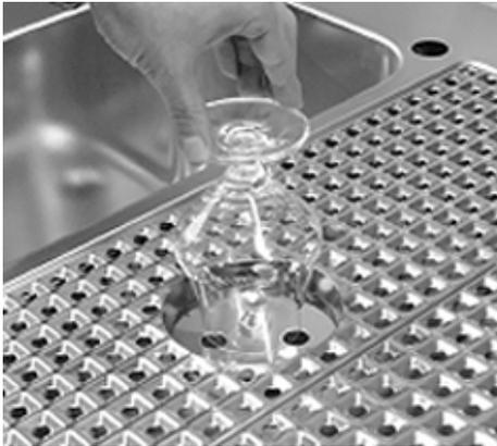
Der Gläserdruckspüler hat die Funktion, ein sauberes Glas von innen zu befeuchten und zu kühlen, um ein besseres Schankergebnis zu erzielen. **Er dient nicht zur herkömmlichen Reinigung von verschmutzten Gläsern.** Der Teller wird mit dem aufgesetzten Glas herunter gedrückt. ⇒ Dadurch wird das Glas von innen mit kaltem, klarem Wasser gespült.
