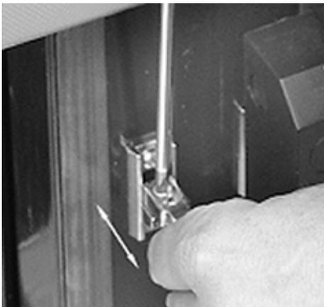
Wenn das Schloss nicht einwandfrei am Schließkloben einrastet, kann der Schließkloben am Kühlkorpus nachjustiert werden. Der Schließkloben ist wie dargestellt verstellbar.
