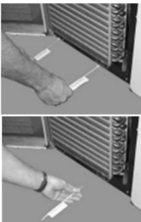
Um das Kälteaggregat vor Beschädigungen während des Transports zu schützen, ist es mit einer Transportsicherung versehen. **Nach dem Aufstellen der Theke die Transportsicherung des Kälteaggregats entfernen und sicher aufbewahren.** Dies gewährleistet ein Freischwingen des Aggregats.
