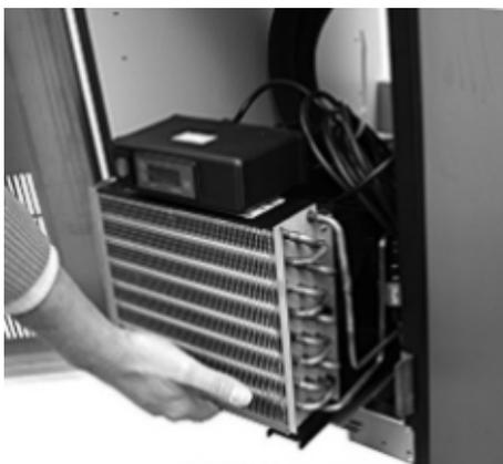
Das Kälteaggregat steht auf Montageschienen und kann ggf. für Wartungsarbeiten oder Anschlussarbeiten des autorisierten Fachpersonals nach vorne herausgezogen werden. Zum Herausziehen des Aggregats muss die Transportsicherung entfernt sein (siehe Kapitel 3).
