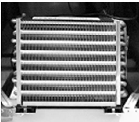
Regelmäßig prüfen, ob der Wärmetauscher am Kälteaggregat durch Staub verschmutzt ist. Nach Bedarf den Wärmetauscher mit einem Handfeger und einem Staubsauger reinigen.
