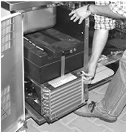
Das kompakte Kälteaggregat mit Verdampfer, Reglereinheit und integrierter Tauwasserverdunstung steht auf einer Konsole und kann nach dem Lösen einer einzigen Schraube nach vorne herausgezogen werden.
